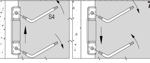
**6** Pour relever le vantail: dévisser légèrement la vis haute, serrer la basse, resserrer la haute. Pour abaisser le vantail: dévisser légèrement la visse basse, serrer la haute. Exécuter ces opérations avec beaucoup de soin en s'aidant avec un levier.
