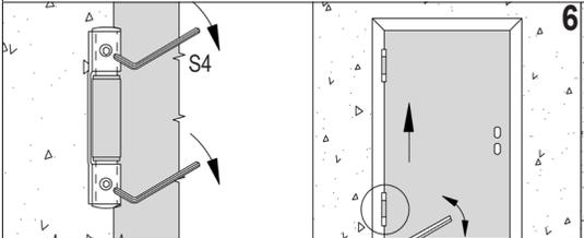
**5** Fermer complètement le vantail, rapprocher les billes de la paumelle portante en agissant sur les deux vis sans tête, mais sans forcer. Exécuter cette opération avec le plus grand soin en allégeant le vantail pour ne pas abîmer la paumelle portante.
