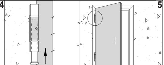
**4** Déballer le vantail sans enlever les entretoises et cales en PA, le positionner dans le dormant. Enfiler l'axe à ressort dans la paumelle axe à ressort, situé en haut pour porte gauche ou en bas pour porte droite.
