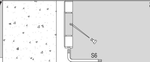
**7** Tendre la paumelle à ressort dans le sens d'ouverture et la bloquer avec le goujon de blocage. Même si la fermeture automatique n'est pas requise ou avec un ferme-porte, bloquer cependant par le goujon.
