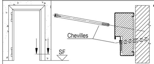
**3** Bloquer provisoirement le dormant, bien d'aplomb dans le tableau, en respectant le niveau du sol fini (SF) et caler si nécessaire contre la cloison. Chevilles de fixation conseillées: pour cloison légère Würth mod. DBL-(WUS-SK)-Z3-180-10x202, pour cloison en béton Spit mod L 10-102/152 (non fournies).
