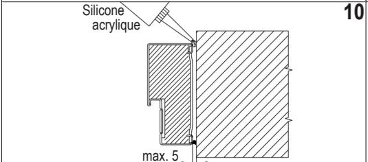
**9** S'il y a des vides excessifs entre le dormant et le mur, il est nécessaire les remplir avec de la laine de roche (non fournie). Appliquer de la silicone acrylique (non fournie) au point de jonction entre dormant et mur.
