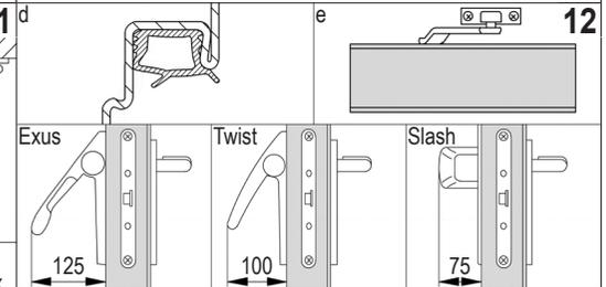
**12** Accessoires: d) joint de fond de feuillure, e) ferme-porte (les pivots à ressorts des paumelles doivent être toujours bloqués avec les goujons), barre antipanique EXUS / TWIST ou SLASH.
