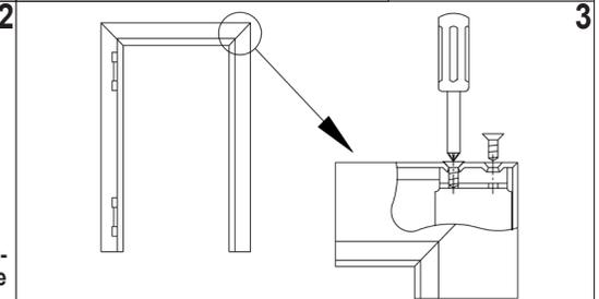
**2** Assembler les profils aux coins du dormant avec les vis autotaraudeuses fournies.
