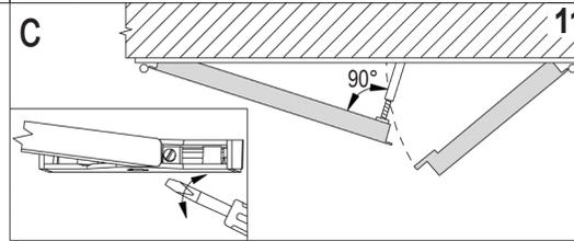
**11** Suivre la même procédure pour la pose des portes à deux vantaux, en ajoutant: a) tendre les deux paumelles à ressort - b) fixer la gâche de sol avec des chevilles - c) en cas de sélecteur de fermeture RC/STD, contrôler son réglage (appui à 90° contre le vantail de service).
