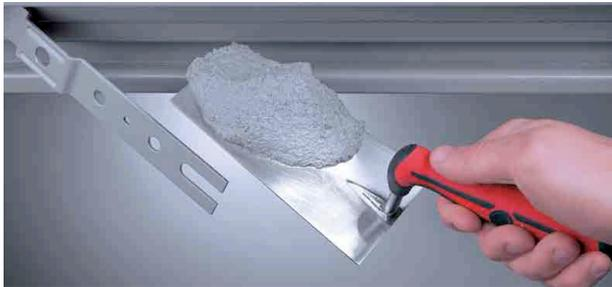
Nel caso di fissaggio con zanche, si consiglia di creare gli scassi adeguati nella parete (sezione 80 x 200 mm) oppure di fissare le zanche con tasselli. Le zanche vanno ripiegate e bloccate nella parete. Ai fini di una buona tenuta meccanica si consiglia di riempire il vuoto tra telaio e muratura con malta cementizia oppure con schiuma poliuretanic; questo riempimento è invece obbligatorio nel caso di porta per esterno marcata **CE**.
