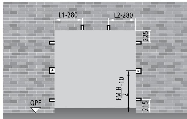
(\*) scassi da realizzare di sezione 200 x 160 mm.
