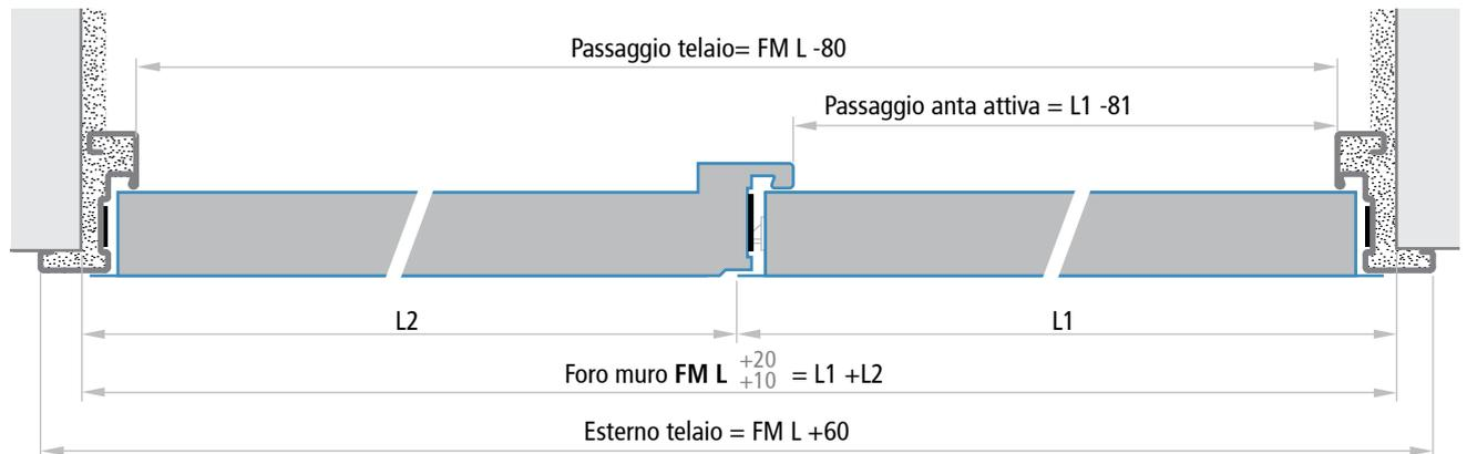
**Porta ad un'anta con telaio su quattro lati e anta con battuta inferiore**
