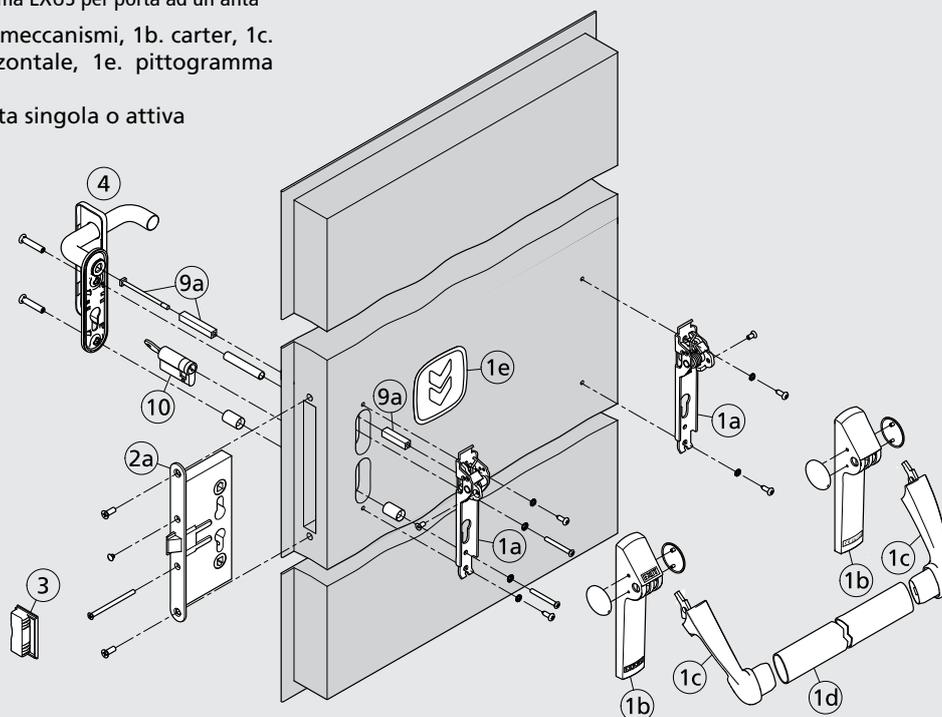
Componenti che fanno parte del sistema EXUS per anta passiva di porta a due ante
