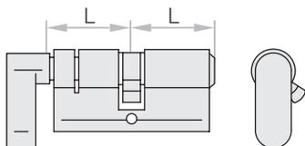
Cylindre simple entrée nickel avec bouton tournant chromé, 3 clés et vis de fixation M5x75mm.
