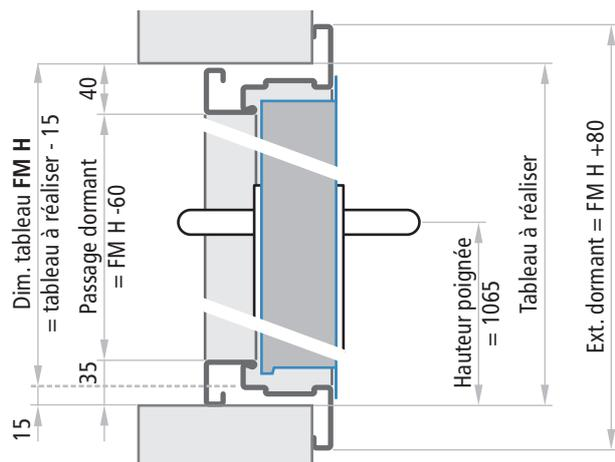
Porte à un vantail avec dormant sur 4 côtés et vantail sans aile de recouvrement basse
