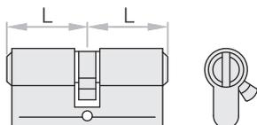
Cylindre double entrée nickel avec 3 clés et vis de fixation M5x75mm.
