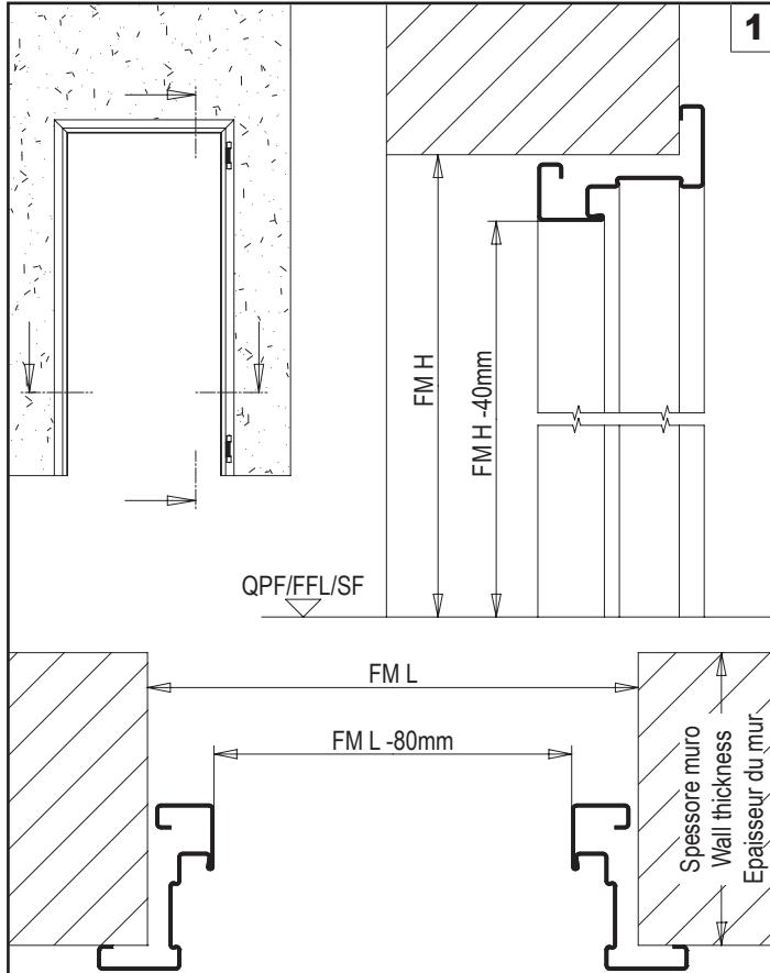
IT: Verificare che le dimensioni della porta e dell'imbotte corrispondano. Controllare lo spessore del muro.
