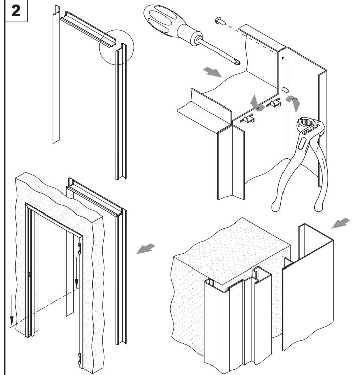
IT: Sballare e assemblare l'imbotte utilizzando le viti autofilettanti in dotazione ( $\varnothing 4,2 \times 13\text{mm}$ ). Infilare l'imbotte nel telaio Proget.
