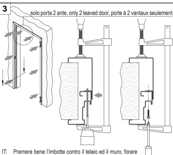
IT: Premere bene l'imbotte contro il telaio ed il muro, forare con punta  $\varnothing 3,5\text{mm}$  l'imbotte attraverso i fori (in quantità variabile) predisposti sul telaio Proget e avvitare le due parti utilizzando le viti autofilettanti in dotazione ( $\varnothing 4,8 \times 25\text{mm}$ ).
