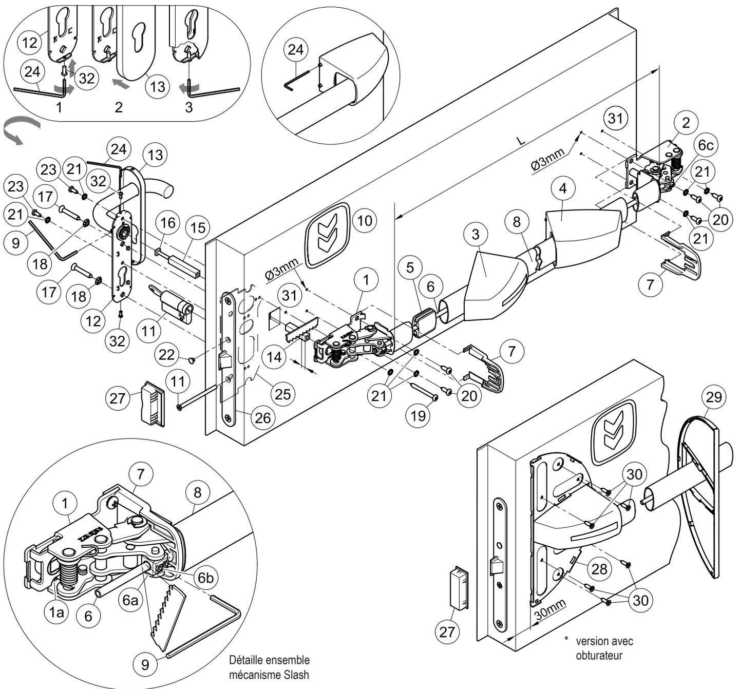
Détaille ensemble mécanisme Slash
