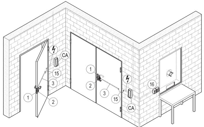
Les deux Kit systèmes MAC et MAC FAILSAFE peuvent être appliqués sur portes à un vantail ou sur vantail actif (de service) des portes à deux vantaux REVER, UNIVER, PROGET.
