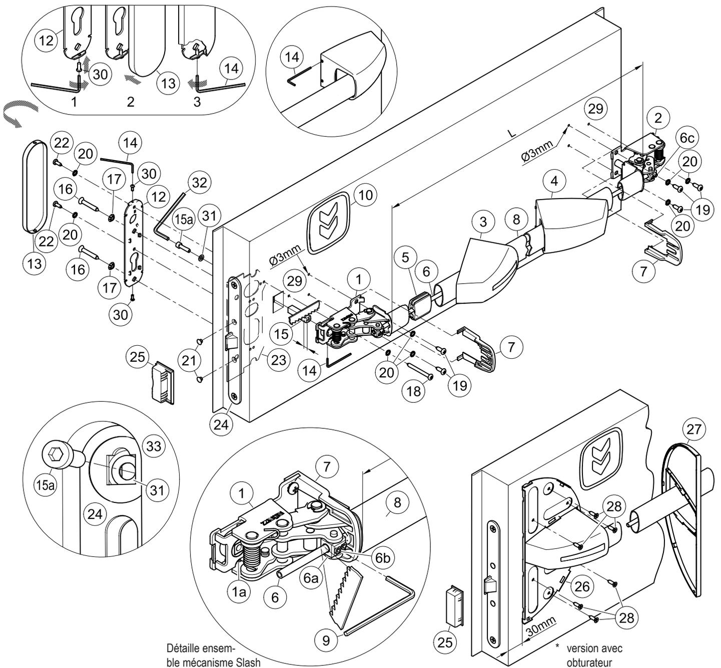
Détaille ensemble mécanisme Slash
