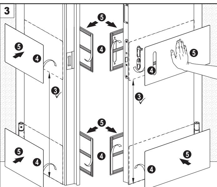
IT: 3) Stabilire l'esatta posizione di ogni fascione/zoccolo. 4) Rimuovere la pellicola protettiva del biadesivo di fissaggio preapplicato. 5) Applicare il fascione/zoccolo nella posizione corretta e ben livellato con l'anta, premendo energicamente per favorirne l'adesione all'anta.
