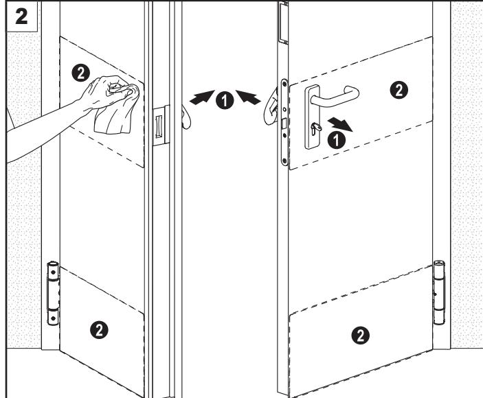
IT: 1) Smontare da ogni anta qualsiasi accessorio eventualmente installato nella zona di applicazione del fascione/zoccolo, seguendo le istruzioni fornite. 2) Pulire accuratamente tali zone.
