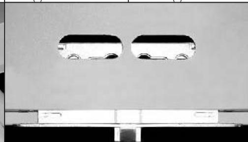
Inserire parzialmente la serratura SECUR. La serratura deve essere in posizione di chiusura.
