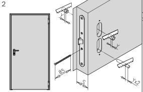
Montare la porta secondo le istruzioni di posa apposite compresi gli accessori e controllare il regolare funzionamento. N.B. per il montaggio di maniglia e/o maniglione invertire i distanziali rispetto alle istruzioni originarie, avendo l'accortezza di non stringere troppo le viti. Prima di murare o di fissare definitivamente la porta eseguire i punti 2a e 2b. Eseguire la regolazione verticale delle cerniere.
