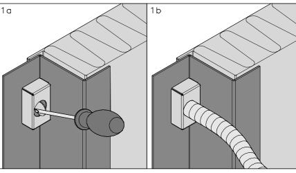
Assemblare il telaio della porta come previsto dalle istruzioni di posa specifiche. Aprire la scatoletta di connessione situata sul retro del telaio lato cerniere ed infilare il tubetto di alimentazione nella scatoletta di connessione.
