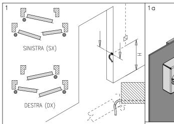
Verificare ed accertarsi del senso di apertura della porta. Controllare la posizione del tubetto di alimentazione. La figura rappresenta l'apertura per una porta destra. H standard = ca. 850mm.
