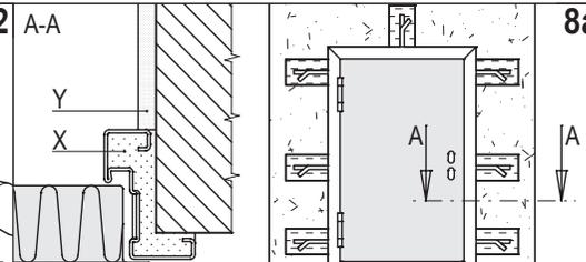
Fixer les pattes avec du ciment à prise rapide. Une fois que le ciment sera bien durci, enlever l'écarteur de pose. En cas de porte coupe-feu, remplir le vide entre dormant et mur avec du ciment (détail X pour porte EI<sub>2</sub>60; X+Y pour porte EI<sub>2</sub>120), en évitant les déformations du dormant.
