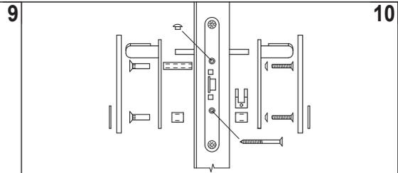
Aprire l'anta, fare i fori nella struttura di sostegno e fissare il telaio con le viti allegate.
