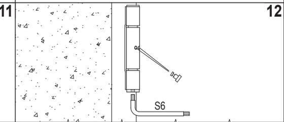
Per alzare l'anta: allentare la vite superiore, stringere quella inferiore, stringere nuovamente quella superiore. Per abbassare l'anta: allentare la vite inferiore, stringere quella superiore. Operazione da eseguire con la massima attenzione aiutandosi con una leva.
