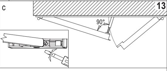
Per porte a due ante con caratteristiche ambientali è obbligatorio il regolatore di chiusura tipo RC2 al posto del RC-STD (part. "c")
