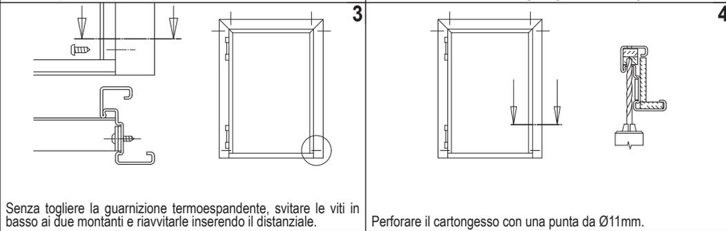
Senza togliere la guarnizione termoespandente, svitare le viti in basso ai due montanti e riavvitarle inserendo il distanziale.
