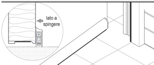
**Figura F VERSIONE CON GUARNIZIONE SOTTOPORTA**
