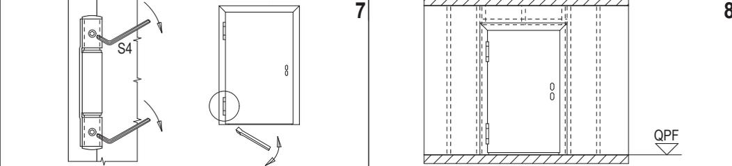
Chiudere l'anta e portare a contatto le sfere della cerniera portante agendo sui grani filettati. Operazione da eseguire con la massima attenzione aiutandosi con una leva.
