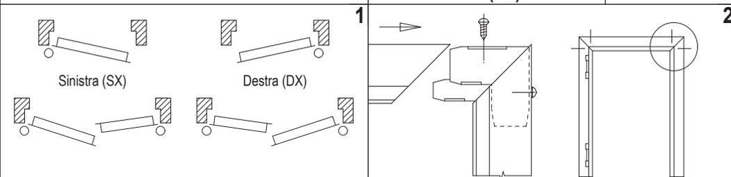
Per porta con caratteristiche ambientali vedere anche le istruzioni complementari allegate. Verificare il senso di apertura della porta e controllare la corrispondenza tra porta e foro della parete esistente.
