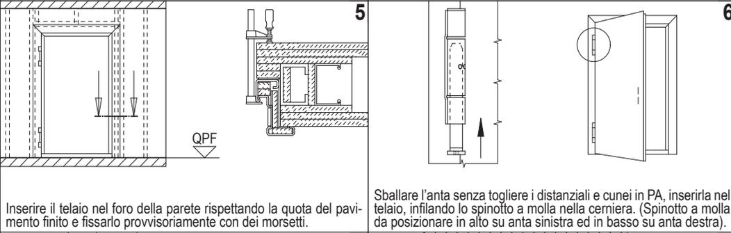
Inserire il telaio nel foro della parete rispettando la quota del pavimento finito e fissarlo provvisoriamente con dei morsetti.
