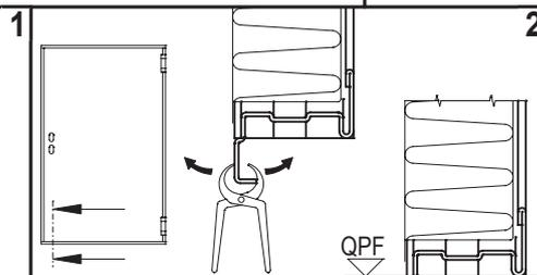
**Per porta con caratteristiche ambientali vedere anche le istruzioni complementari allegate.** Sballare la porta, controllare che il foro muro corrisponda alla misura FM dell'etichetta applicata sul telaio. Stabilire la definitiva quota del pavimento finito (QPF) e il senso di apertura. Verificare che la parete sia del tipo in blocchi, in muratura o in calcestruzzo omogeneo con una densità di 1200±400 kg/m<sup>3</sup> ed uno spessore di min. 150mm.
