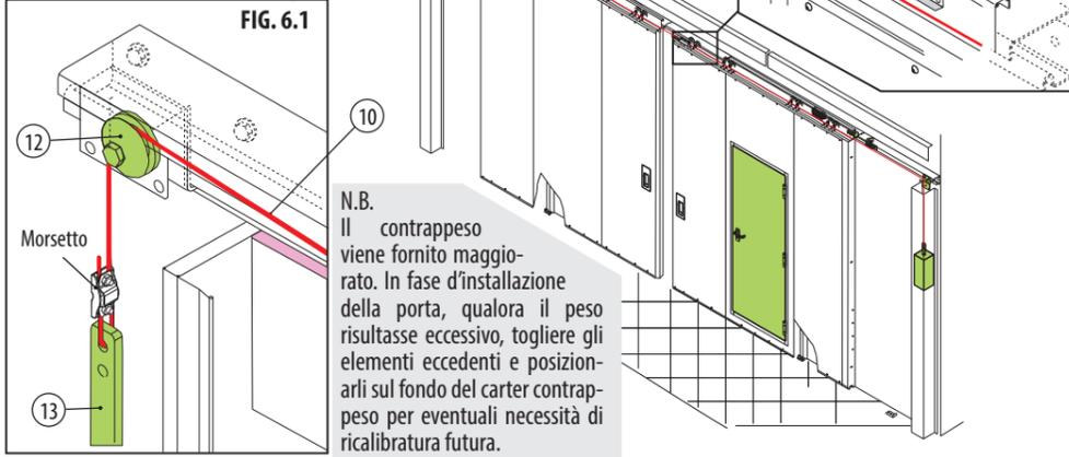
**FIG.7.1 VERSIONE CONTRAPPESO DISASSATO\*\***
