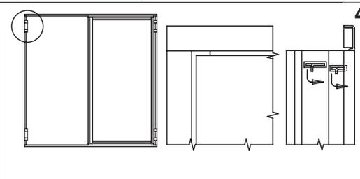
Assembler les deux traverses et l'autre montant, en insérant les ailettes à encastrement en leurs sièges. Tordre les ailettes pour bloquer les quatre angles du dormant.
