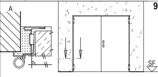
Remplir avec du ciment le vide entre le dormant et le mur (détail A), en évitant toute déformation ou effet de flèche du dormant.
