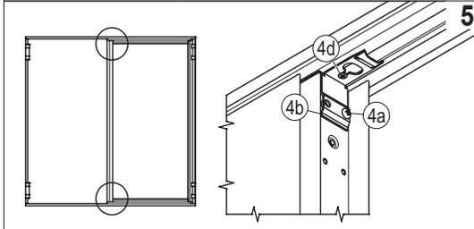
Visser avec les vis (4d), fournies dans la boîte de la poignée, les deux équerres (4b) positionnées en haut et en bas du joint central afin de bloquer les traverses au semi-fixe.
