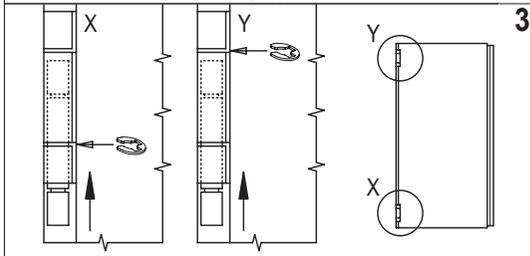
Appliquer un montant dormant sur le vantail semi-fixe en enfilant les deux axes paumelle avec les anneaux d'arrêt fournis. Attention ! Opération très délicate.
