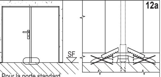
Pour la porte standard fixer la gâche de sol pour la tringle du vantail semi-fixe avec vis/cheville + une goutte de silicone et enlever les quatre ailettes débordantes.
