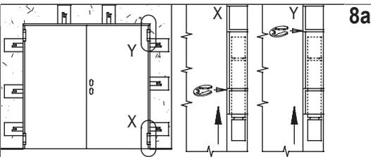
Monter le vantail de service comme pour l'assemblage des paumelles du vantail semi-fixe. Fixer les pattes avec du ciment à prise rapide. Quand la fixation est bien solide, enlever les équerres en libérant le vantail semi-fixe. Il est impératif de visser à nouveau les deux vis (part. 4a - sch. 5) en haut et en bas du vantail semi-fixe.
