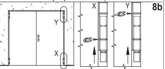
Enlever les équerres en libérant le vantail semi-fixe. Il est impératif de visser à nouveau les deux vis (part. 4a - sch. 5) en haut et en bas du vantail semi-fixe. Cheviller dans la cloison comme décrit au point précédent et fermer le vantail. Monter le vantail de service comme pour l'assemblage des paumelles du vantail semi-fixe.
