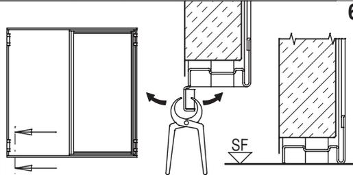
En faisant attention, détacher le couvre-joint de la traverse basse pour une bonne application sur le sol fini (SF).
