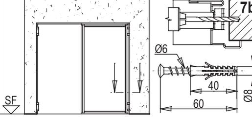
Bloquer provisoirement la porte, bien d'aplomb, en respectant le sol fini (SF) et le parallélisme par rapport à la cloison. Cheviller la partie découverte du dormant par les trous prévus, en utilisant des chevilles 8x40mm et des vis 6x60mm (non fournies).
