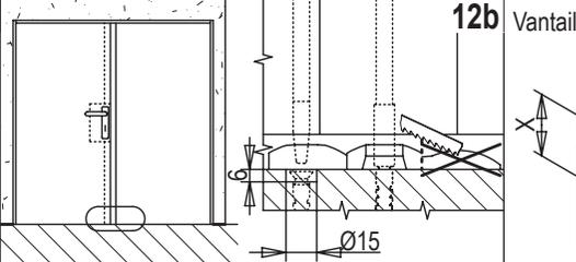
Pour la porte SECUR enfilez l'insert Secur dans la gâche de sol et fixer l'ensemble pour les tringles verticales avec deux vis/chevilles. Enlever les deux ailettes débordantes.
