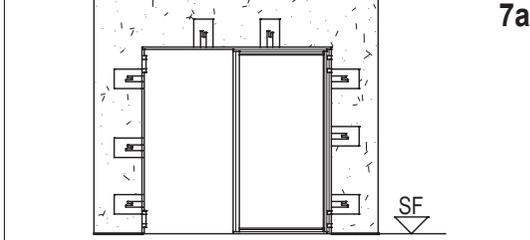
Redresser les pattes de fixation, créer les trous dans la maçonnerie. Bloquer provisoirement la porte, bien d'aplomb, en respectant le sol fini (SF) et le parallélisme par rapport à la cloison.
