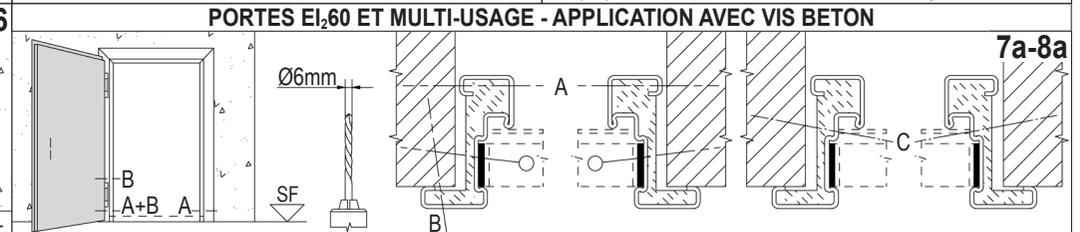
Déballez le vantail sans enlever les entretoises et cales en PA, le positionner dans le dormant. Enfiler l'axe à ressort dans la paumelle axe à ressort, situé en haut pour porte gauche et en bas pour porte droite.
