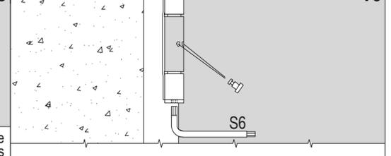
Perçer le dormant aux points indiqués ci-dessus (⊙) et le fixer avec des vis Ø6x45mm et chevilles en plastique Ø8x40mm. Les chevilles et les vis ne sont pas fournies.
