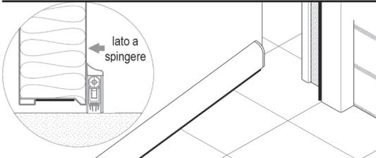
**Figura F VERSIONE CON GUARNIZIONE SOTTOPORTA**
