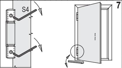
Portare a contatto le sfere della cerniera portante agendo sui grani filettati. Operazione da eseguire con la massima attenzione aiutandosi con una leva.
