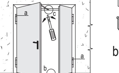
Seguire la stessa procedura di posa per porte a due ante, aggiungendo: a) caricare 2 spinotti a molla; b) tassellare la boccola a pavimento; c) se presente, registrare il regolatore di chiusura RC/STD (appoggio a 90° contro l'anta principale).
