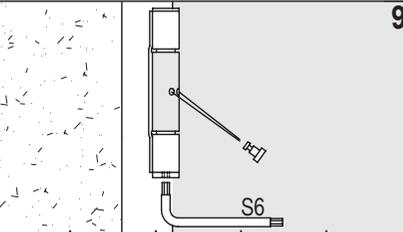
Caricare la cerniera a molla nel senso dell'apertura e infilare il nottolino d'arresto. Anche in combinazione con chiudiporta caricare comunque leggermente la molla ed infilare il nottolino.
