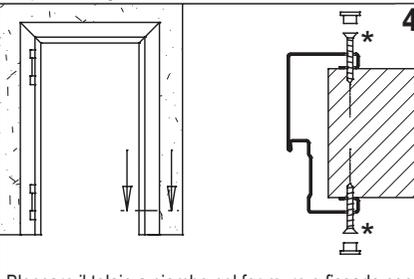
Bloccare il telaio a piombo nel foro muro e fissarlo con viti attraverso i fori predisposti e montare i tappi.
