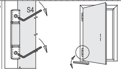
Portare a contatto le sfere della cerniera portante agendo sui grani filettati. Operazione da eseguire con la massima attenzione aiutandosi con una leva.
