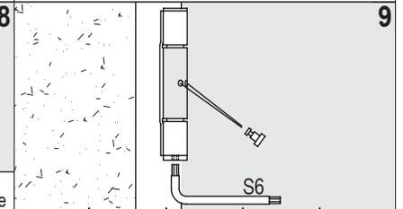
Caricare la cerniera a molla nel senso dell'apertura e infilare il nottolino d'arresto. Anche in combinazione con chiudiporta caricare comunque leggermente la molla ed infilare il nottolino.
