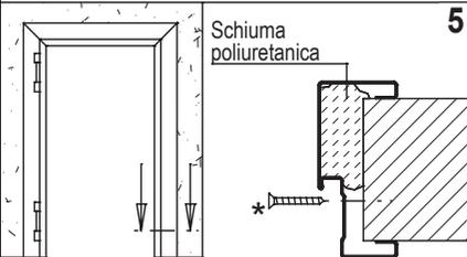
Fissare ulteriormente il telaio attraverso i fori predisposti nella battuta spessorando se occorre contro la parete oppure inserire schiuma poliuretanic.
