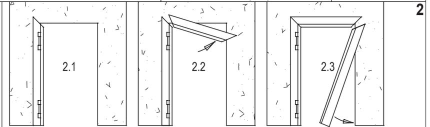
Infilare nel foro parete i singoli profili del telaio secondo le presenti figure.
