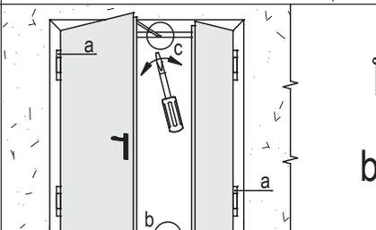
Seguire la stessa procedura di posa per porte a due ante, aggiungendo: a) caricare 2 spinotti a molla; b) tassellare la boccia a pavimento; c) se presente, registrare il regolatore di chiusura RC/STD (appoggio a 90° contro l'anta principale).
