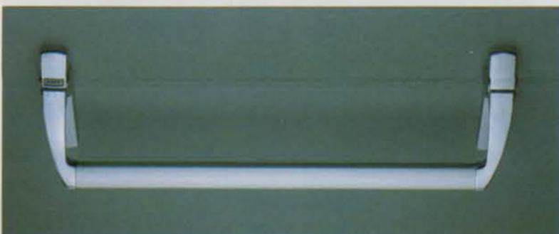
Maniglione antipanic EXUS con serratura inserita nella porta, modello EXUS LA con 2 meccanismi in acciaio zincato, carter e bracci in lega di alluminio finitura cromato lucido (cromo trivalente secondo le norme ROHS), barra in estruso di alluminio anodizzato.
