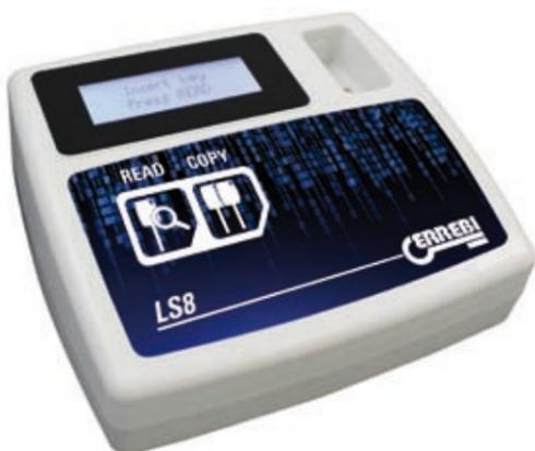
LS8, macchina elettronica per la duplicazione del transponder chiavi auto con 2 pulsanti per la lettura e copia del transponder (Errebi).
