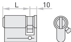
Demi-cylindre simple entrée nickel avec 3 clés et vis de fixation M5x75mm.
