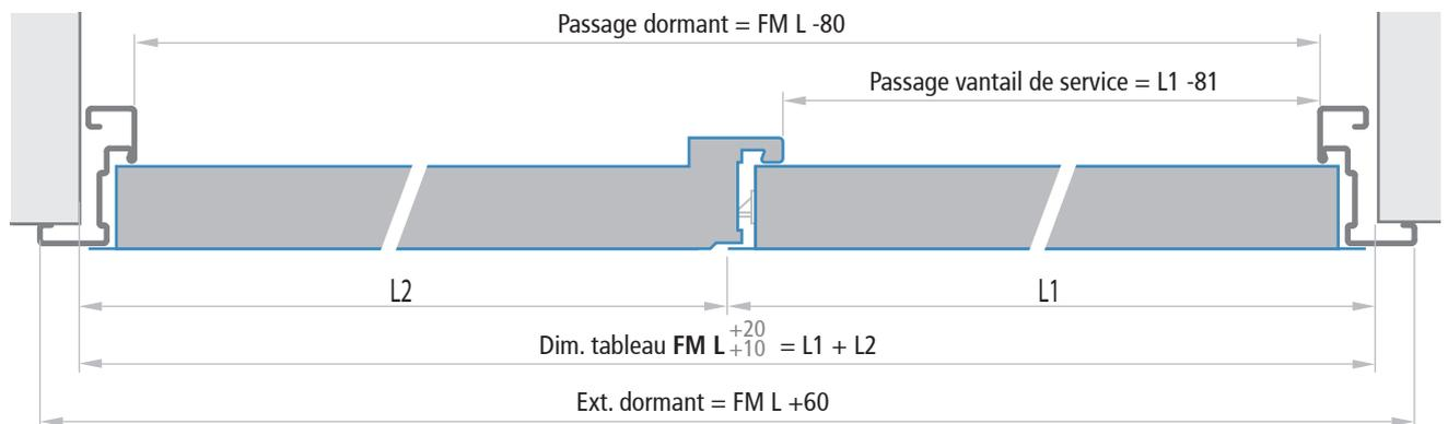
**Porte à un vantail avec dormant sur 4 côtés et vantail avec aile de recouvrement basse**
